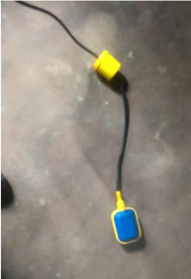
우물넘침방지센서(왼쪽) 및 설치 위치 (오른쪽)
